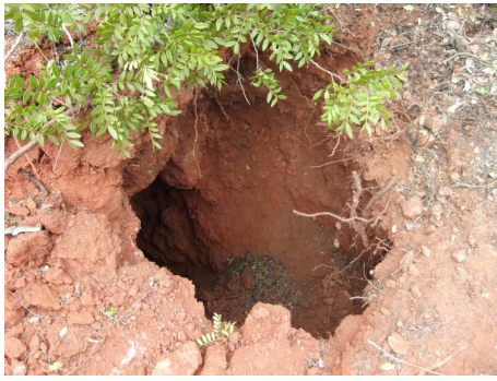
Figura 7 – Vazio junto à sondagem S1, com cerca de 1 m de diâmetro e profundidade mínima de 5 m (à esquerda).
