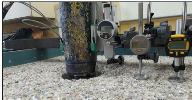
Figura 7 – Ruptura da fundação sem reforço
