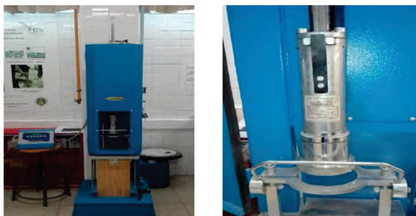
Figura 4 - Compactador Marshall (esquerda) e respetivo martelo de compactação (direita)
