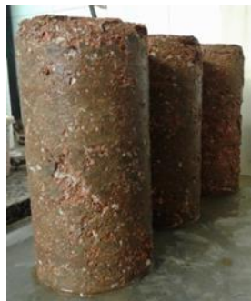
Figura 6 - Desintegração do corpo de prova moldado para compressão simples após a imersão em água por 4 horas
