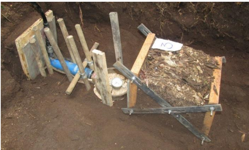
Figura 4 - Teste II - Bloco de prova fixado ao solo apenas pela base
