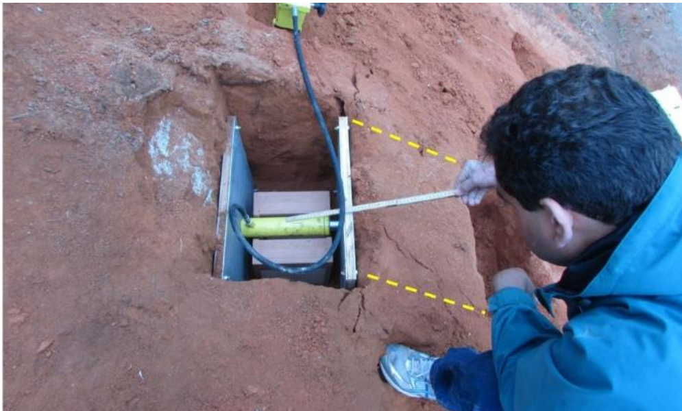
Figura 3 - Teste I - Bloco de prova fixado ao solo pela base e pelas paredes laterais
