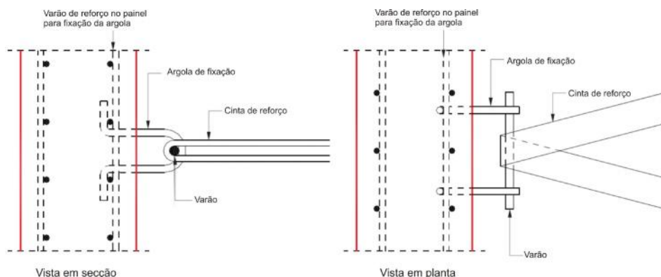
Figura 2 - Esquema com ligação das cintas às placas de betão do muro (Adaptado de Linear Composites, 2009).
