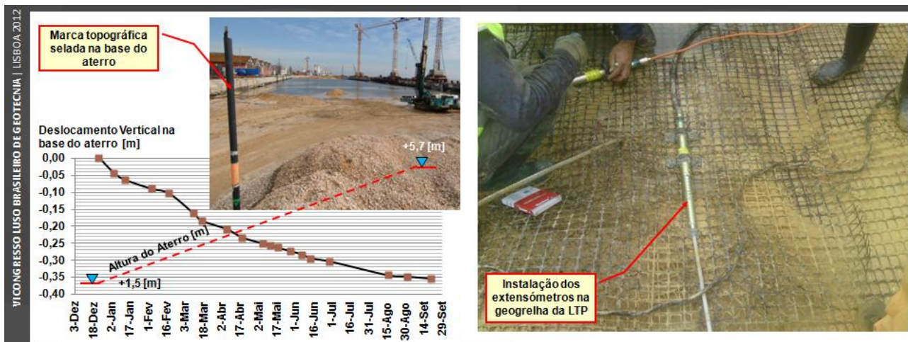
Figura 8 – Andamento dos Deslocamentos Verticais e Instalação de um Extensómetro
