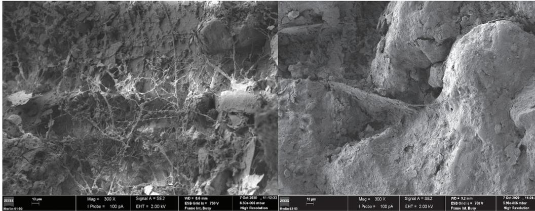
Figura 3 - À esquerda: imagem SEM da mistura Lab XG + soil. À direita: imagem SEM da mistura XG Comercial + soil.
