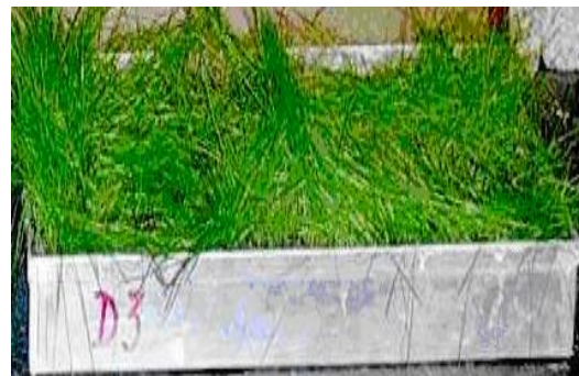
Figura 3 – Preparação de amostras para ensaio de provetes com cobertura vegetal (relva)
