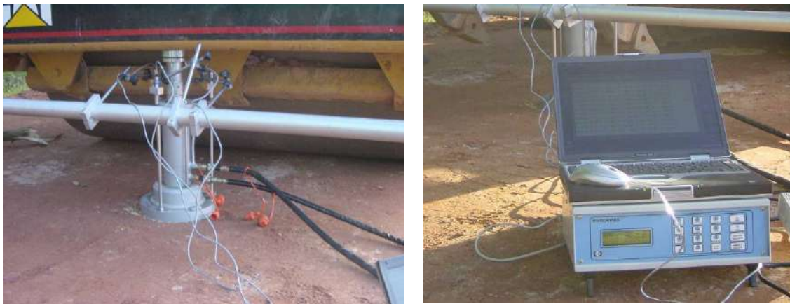
Figura 10 – Aspectos do Ensaio de Placa
