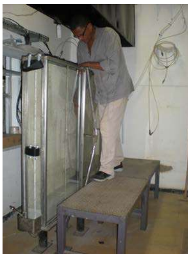
Figura 2 - Canal de fluxo em processo de compactação da areia. Vista das barras de reforço da estrutura em aço na parte frontal, da parede de fundo revestida com epóxi, e da lateral para fixar tubo Mariotte.
