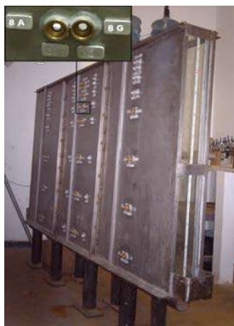
Figura 3 - Vista da parede do fundo do canal, em aço inox, com os trinta acoplamentos para inserir os tensiômetros.
