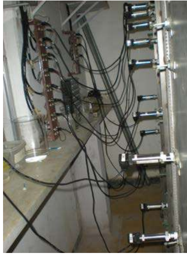
Figura 6 - Vista da parede de fundo do canal com tensiômetros acoplados ao canal e ao sistema de aquisição de dados.
