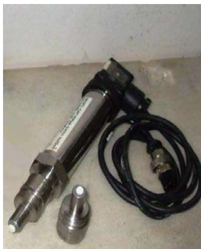
Figura 5 - Tensiômetro de baixa capacidade e luva de acoplamento com ponta porosa.
