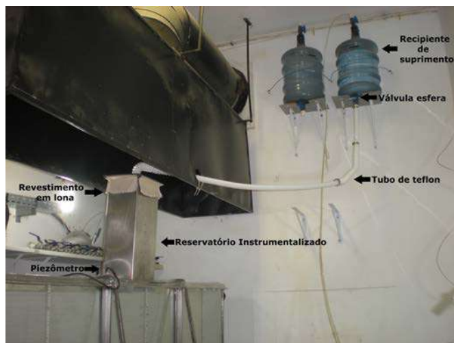
Figura 4 - Reservatório em aço, de fundo poroso, colocado no topo do solo e, sistema acoplado para fornecimento do líquido ao reservatório.
