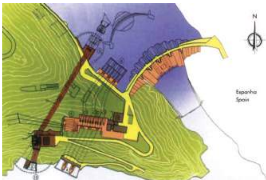
Planta geral com o traçado dos circuitos hidráulicos, vendo-se a localização da central subterrânea (Miranda I) junto ao encontro direito da barragem e o reforço de potência com a central em poço (Miranda II). General view of the hydraulic circuit, showing the location of the underground powerhouse (Miranda I) beside the right-hand abutment of the dam and the repowering with the powerhouse shaft (Miranda II).
