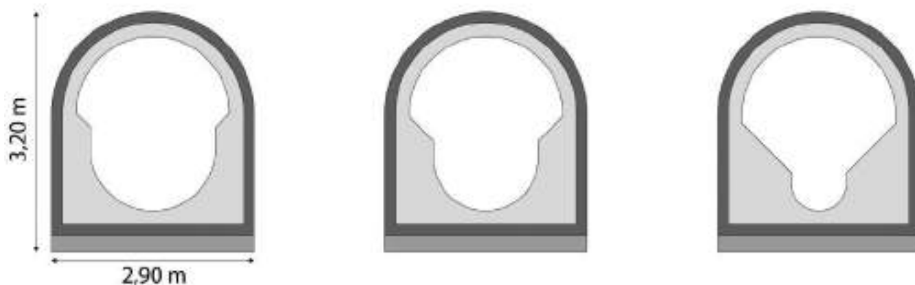
Fig. 02 Variação das secções de revestimento definitivo (troço do Intercetor Jamor-Lage). Section variations and final lining (Jamor-Lage Collector Section).
