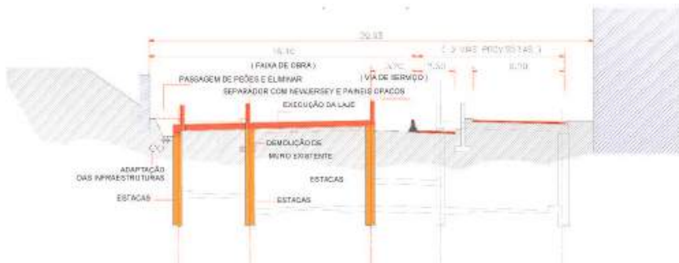
Fig. 04 Secção tipo no trecho Amoreiras – Rua Artilharia Um. Cross-section through the Amoreiras Section – Artilharia Um Street.
