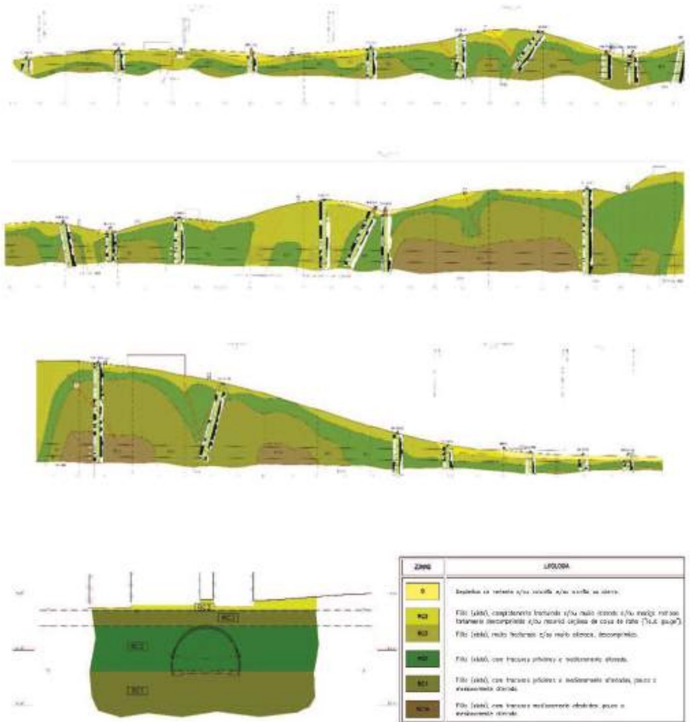
Perfis geológico-geotécnicos longitudinal do túnel e transversal na zona de menor recobrimento. Longitudinal and transversal geological and geotechnical profiles of the tunnel at shallow areas.
