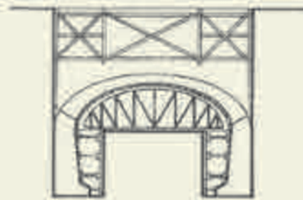
4 - Colocação do cimbre, para a execução da abóbada
