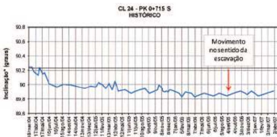
Fig. 11 Exemplo das deformações da medição com clinómetro portátil num edifício. Angular deformations measured at a building facade with portable clinometer.
