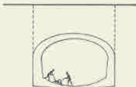
7 - Betonagem da soleira
