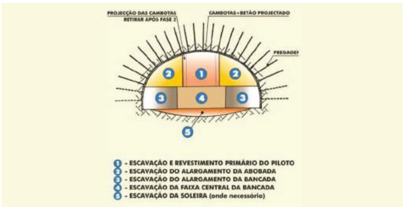
Esquema de escavação para a Zona Geotécnica ZG2. Excavation scheme for the Geotechnical zone ZG2.
