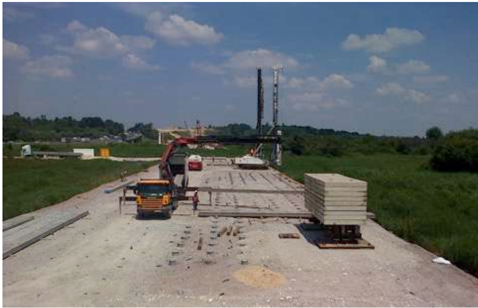
Ensaio de carga estático executado com equipamento de cravação como estrutura de reacção
