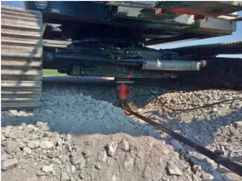
Ensaio de carga estático executado com equipamento de cravação como estrutura de reacção
